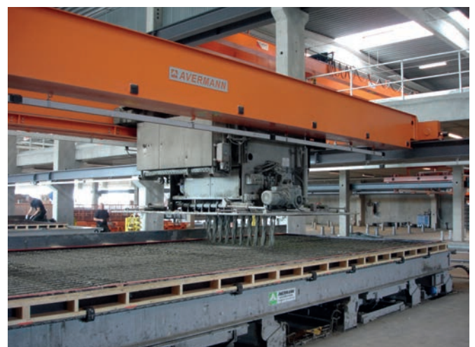
Рис. 5: Станция бетонирования с бетонораздатчиком и уплотняющим вибратором Avermann
